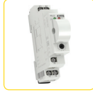
PRI-32 Měření přes proudové trafo (vodíč skrz otvor, galv. oddělené, bez tepelných ztrát), nast. proud 1-20 A, UNI napájení AC 24 - 240 V DC 24 V, výstup 8 A přep. Str.: 84
