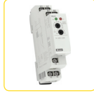
PRI-51 Měření proudu pomocí vestavěného proudového trafo, 5 rozsahů (ve variantách 1/2/5/8/16 A), rozsah 5 A je vhodný pro proudový transf. (X/5), napájení a výstup jako PRI-32, rozdíl oproti PRI-32: přímé měření a jemnější rozsahy (vyšší citlivost) = přesnější měření. Str.: 85
