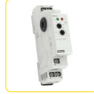
PRI-52 Ke snímání proudu až do 25 A. Diagnostika vzdáleného zařízení (zkratu, zvýšení odběru). Přednostní (prioritní) relé. Napájecí napětí AC 230 V, výstup 8 A přep. Str.: 88
