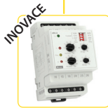
HRH-8 8 funkcí, pokročilé nastavení pro různé kombinace, galvanicky oddělené napájení AC 230 V, AC 110 V nebo AC/DC 24 V, 2 výstupní kontakty 16 A. Str.: 96
